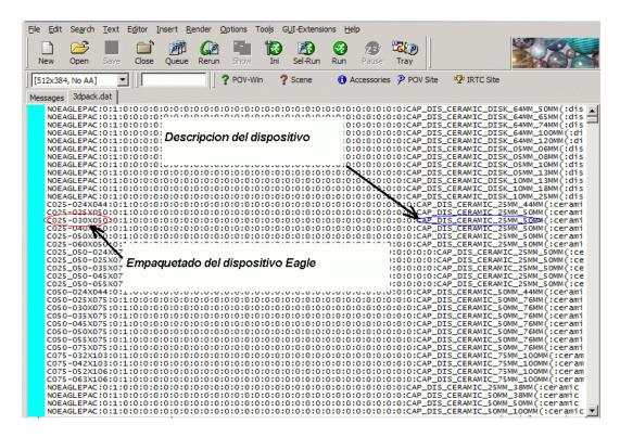
Podemos ver que para el dispositivo señalado del lado izquierdo de la ventana se tiene el empaquetado del dispositivo y del lado derecho se tiene la descripción del dispositivo que usa el empaquetado. En este caso el dispositivo es un capacitor cerámico CAP DIS CERAMIC 25MM 50MM y su paquete (package) es C025-030X050.
