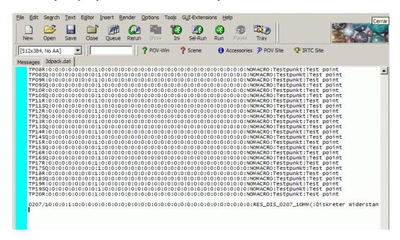
Y le cambiamos el nombre del paquete 0207/10 por el de R-10 que es el paquete que emplea la resistencia usada en la placa "AdaptadorQY.brd".
