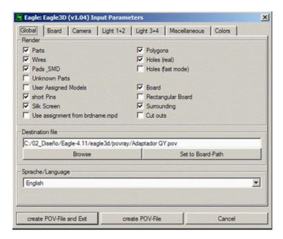
Mediante este menu podemos configurar la forma en que deseamos que aparezca la placa del circuito impreso, es decir podemos escoger el angulo de la imagen a desplegar, el color de la placa, el color de la mascarilla antisoldante, las fuentes de luz empleadas, la generación de sombras, etc.
